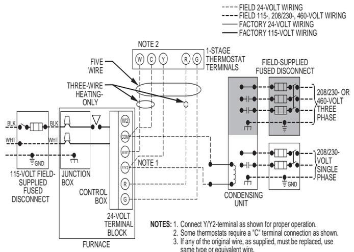
**Fig. 25 – Field Wiring Diagram**
