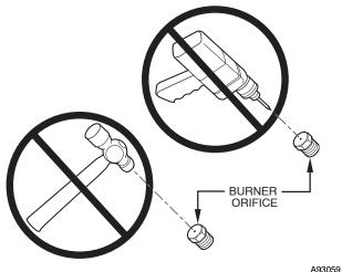
Fig. 60 - Orifice Hole
